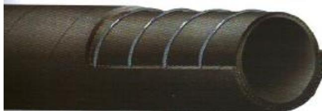
Cijev: glatka EPM guma crne boje otporna na ozon, kisik, toplinu, vodenu paru, kemikalije i starenje - nije otporna na mineralna ulja, aromatske rastvore, alifate i spojeve na bazi klora
