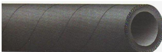
Cijev: glatka EPM guma crne boje otporna na ozon, kisik, toplinu, vodenu paru, kemikalije i starenje - nije otporna na mineralna ulja, aromatske rastvore, alifate i spojeve na bazi klora
