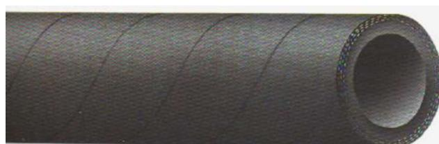
Cijev: glatka EPM guma crne boje otporna na ozon, kisik, toplinu, vodenu paru, kemikalije i starenje - nije otporna na mineralna ulja, aromatske rastvore, alifate i spojeve na bazi klora
