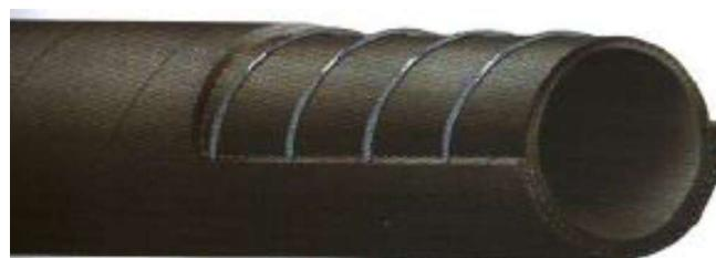
Cijev: glatka EPM guma crne boje otporna na ozon, kisik, toplinu, vodenu paru, kemikalije i starenje - nije otporna na mineralna ulja, aromatske rastvore, alifate i spojeve na bazi klora
